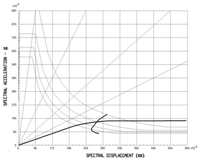
**b. FEMA 356 - Displacement Coefficient Method**
